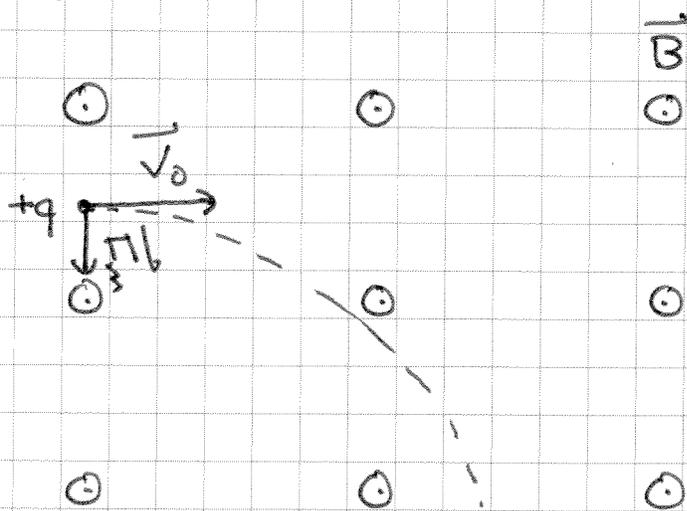
$$\text{Since } \vec{F} = q\vec{v} \times \vec{B}, \quad \vec{F} \perp \vec{v}, \quad \vec{F} \perp \frac{d\vec{r}}{dt}$$
