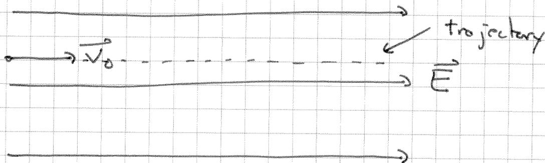
If  $\vec{v}_0 = v_0 \hat{x}$ ,  $x(t) = x_0 + v_0 t + \frac{1}{2} a t^2$
